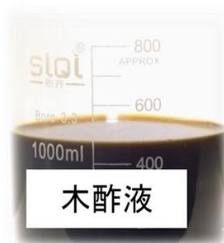
低温炭化装置を稼働する上で副産物として、炭化灰と木酢液が生成されます。投入される有機廃棄物の種類や物資割合によって、生成物質も変化しますので、排出された炭化灰と木酢液は成分検査を実施したうえ、設置自治体のルールに従って回収処理が必要です。生成量に応じて、再資源化リサイクルなども可能です。
